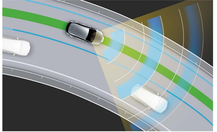
车道偏离警示系统LDA/智能车道循迹系统LTA
