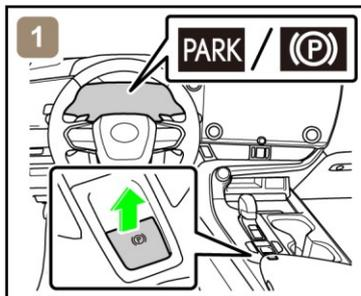
1) 用模块楔住车轮并接合驻车制动。
